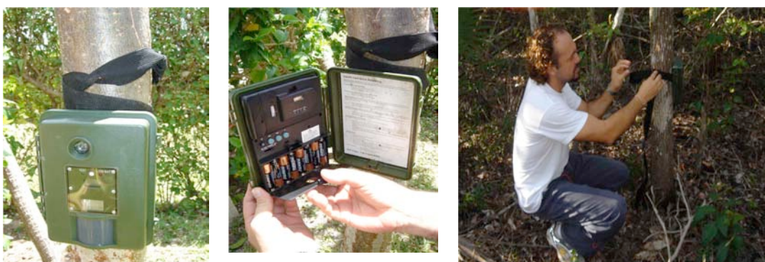
Figura 7. Tipo de cámara fija con sensor de movimiento e instalación de la misma
